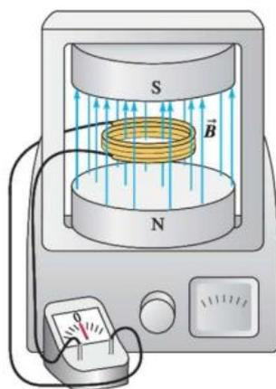
**Figura 6.** Uma bobina em um campo magnético. Quando esse campo magnético é constante não existe nenhuma corrente induzida, a orientação e forma da bobina permanecem constantes. Quando alterarmos qualquer um desses três fatores, surge uma corrente induzida. Fonte: Adaptado do Livro Física III, Eletromagnetismo. 14a. ed. São Paulo: Editora Pearson Brasil, 2016.
